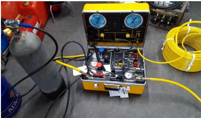
水位測定装置(A)エアーコントロール装置
